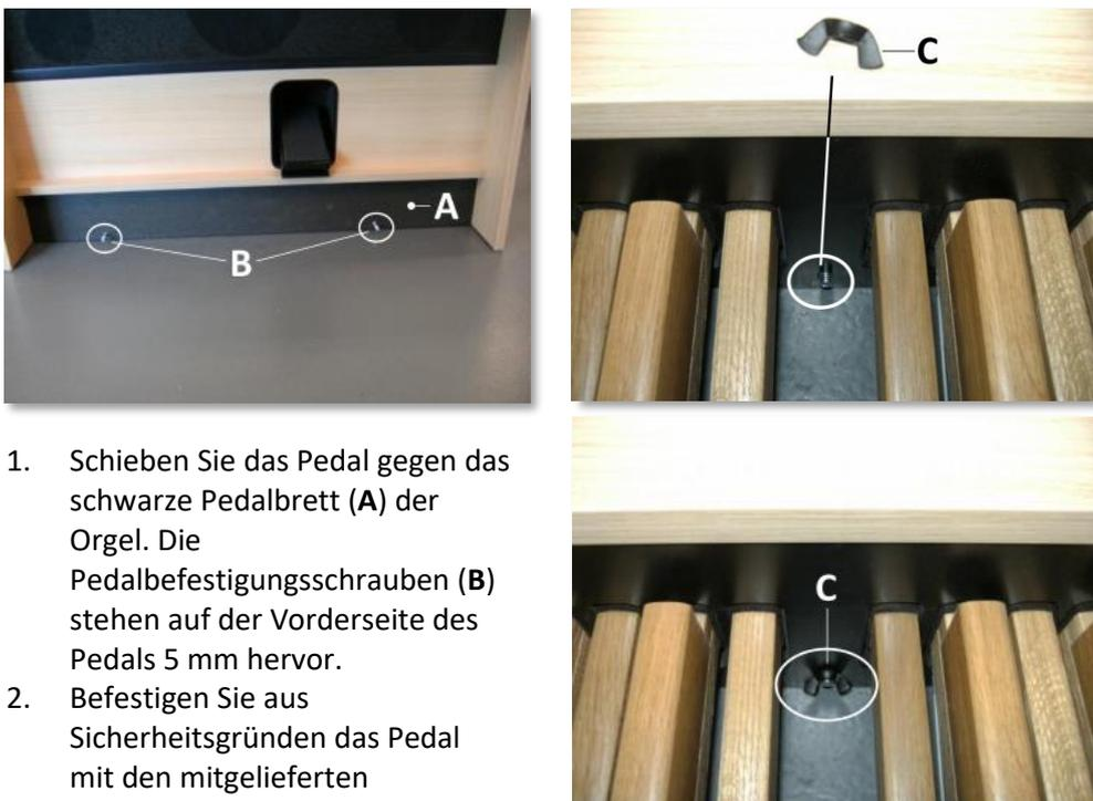
1. Schieben Sie das Pedal gegen das schwarze Pedalbrett (A) der Orgel. Die Pedalbefestigungsschrauben (B) stehen auf der Vorderseite des Pedals 5 mm hervor.
